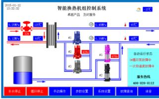
主要用于换热机组控制和变频温度循环控制。
